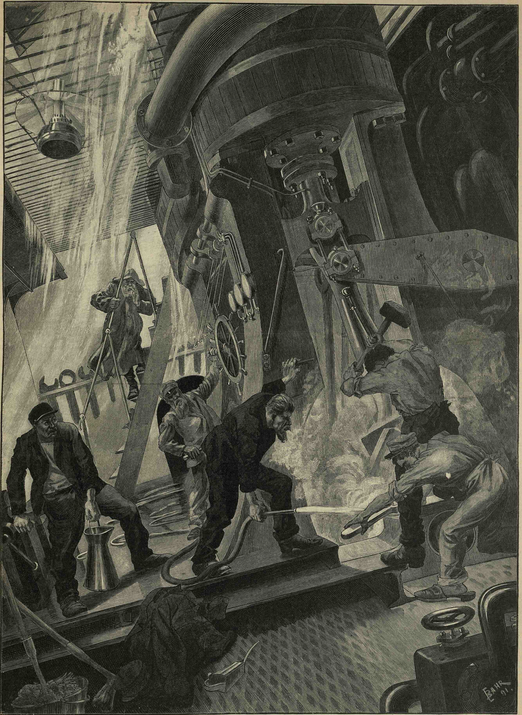
Heißlaufen einer Schiffs-Schraubenwelle. Originalzeichnung von J. Bahr.
